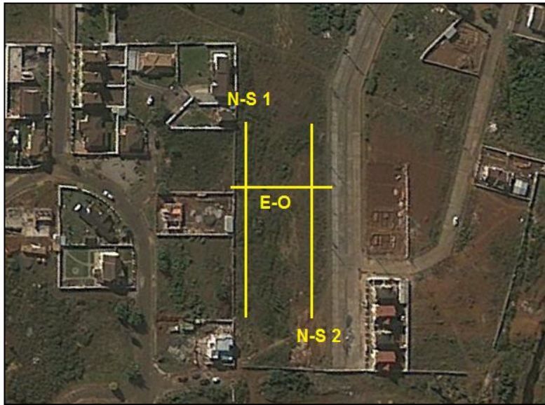
Figura 11. Disposición de mediciones. Lomas de Bellavista, Concepción.
