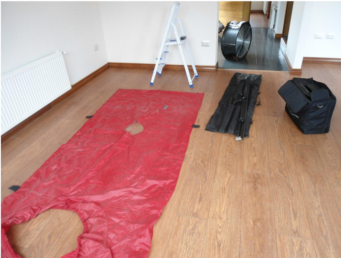
Figura 6: Equipamiento del Blower-Door.
