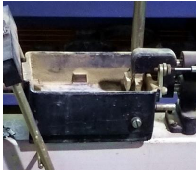
Figura N° 21 “Contenedor y caja de corte”
