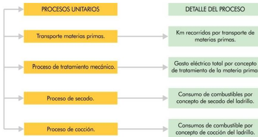
Ilustración 3-45: Diagrama de Flujo proceso fabricación ladrillo cerámico (elaboración propia, 2010)
