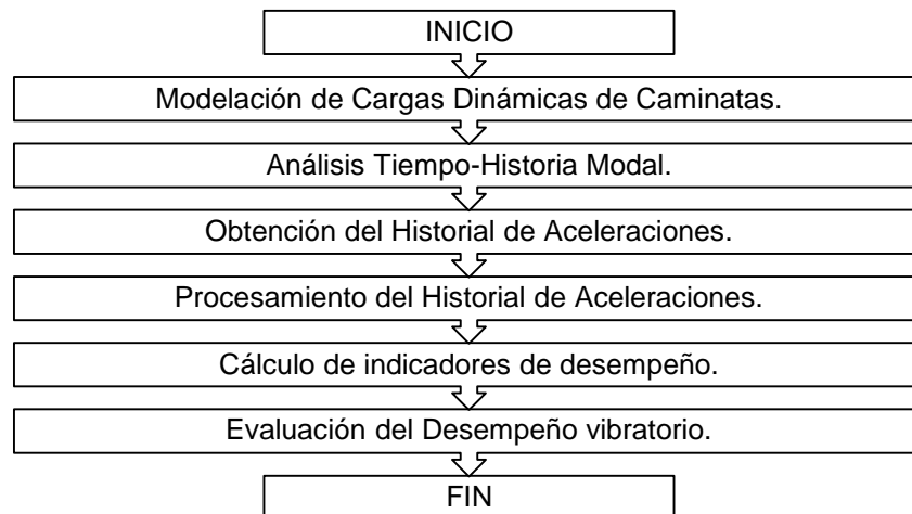
Figura 5. Procedimiento de Análisis aplicado a los Sistemas de Pisos en Estudio (Elaboración Propia).
