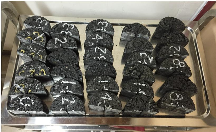
Figura 2. Muestras para ensayo Fénix.
