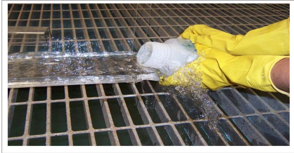
Figura 20: Toma de muestra de agua residual en canal base.
