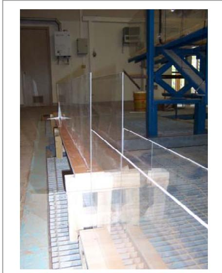
Figura 14: Canal con Caída Hidráulica.
