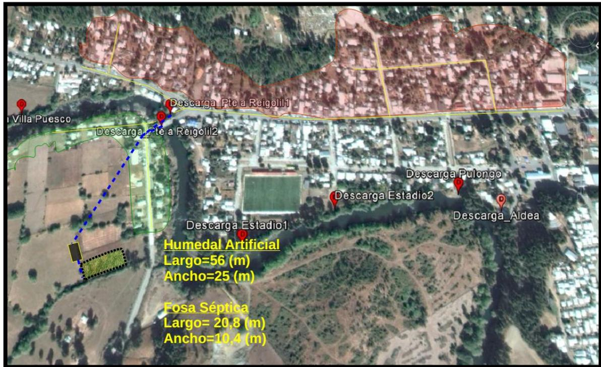
Figura N° 11, Ubicación Sistema de Tratamiento para descargas 2 y 3
