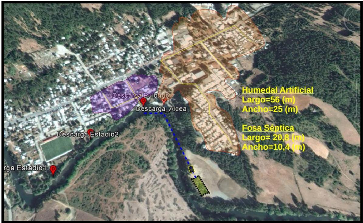
Figura N° 13, Ubicación Sistema de Tratamiento descargas 6 y 7
