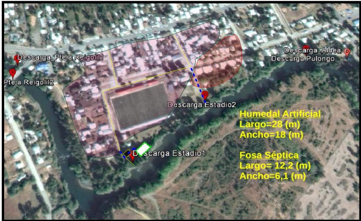
Figura N° 12, Ubicación Sistema de Tratamiento descargas 4 y 5
