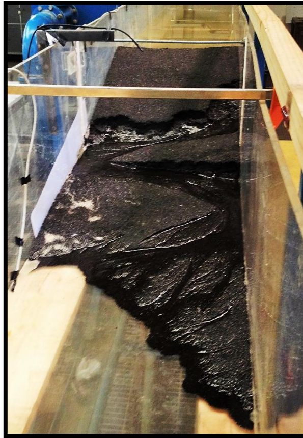
Figura N° 4. Mecanismo de falla en terraplén de talud 4/1.
