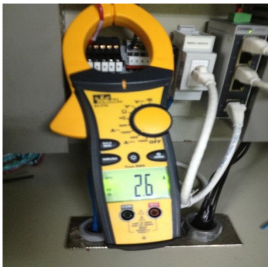
Figura 6.1, Medición de consumo de energía de una unidad CSI 6500.
