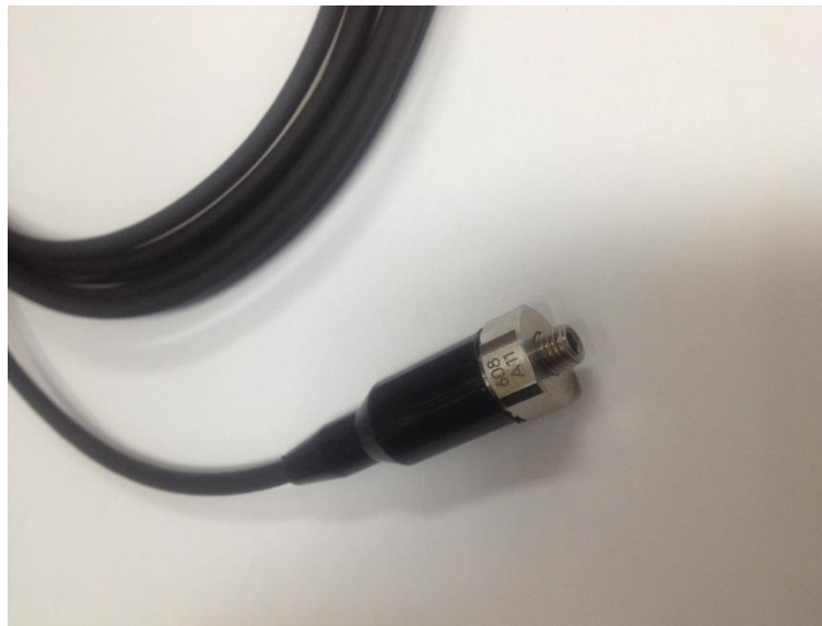
Figura 2.1, Acelerómetro de 100mv/g utilizado en Planta Celulosa Arauco.
