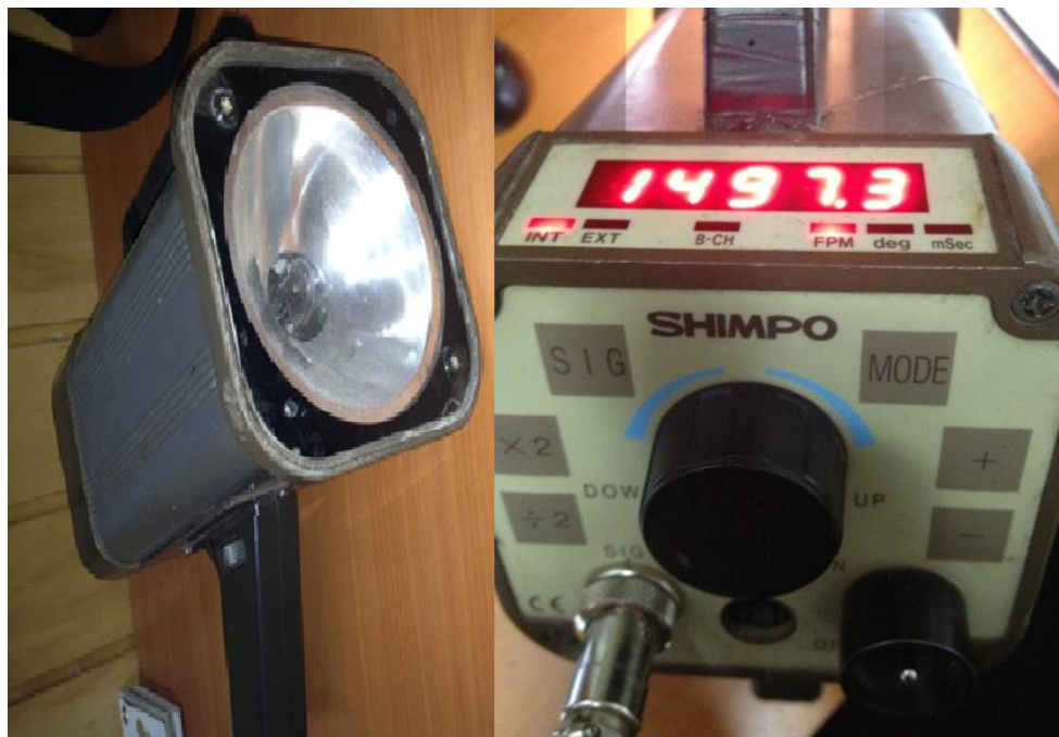
Figura 6.2, Lámpara estroboscópica con variador de frecuencia que permite medir velocidad de giro de un rotor.
