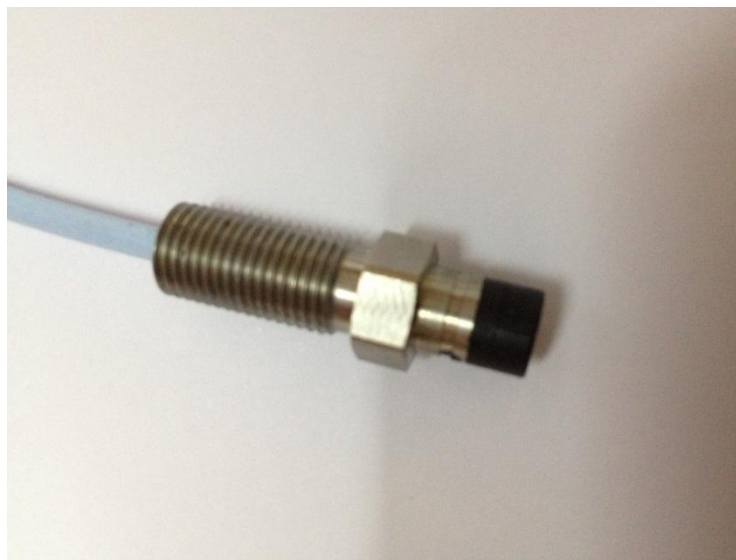
Figura 2.2, punta de un sensor de desplazamiento Bently Nevada 3500 usado en turbogeneradores.
