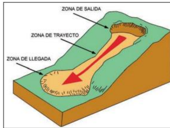
Figura 5. Esquema de una colada fangosa
