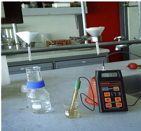
Figura 3.10. Medición de pH.
