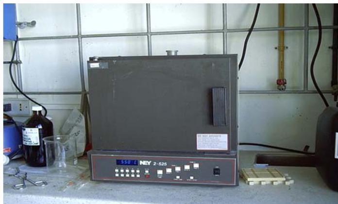
Figura 3.8: Mufla utilizada para calcinar la muestra a ensayar.
