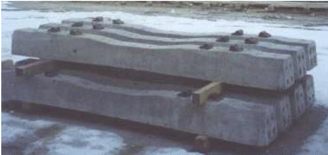
Fig. 2.14. Durmiénte de hormigón. 17
