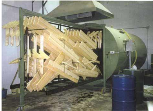
Figura N° 7.29: Cámara de Impregnación para productos terminados.
