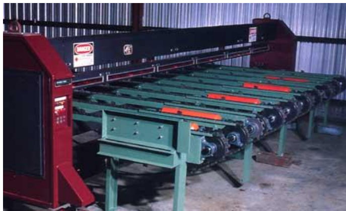
Figura N° 7.7: Escáner de cortina para medición transversal, o barrera de fotoceldas
