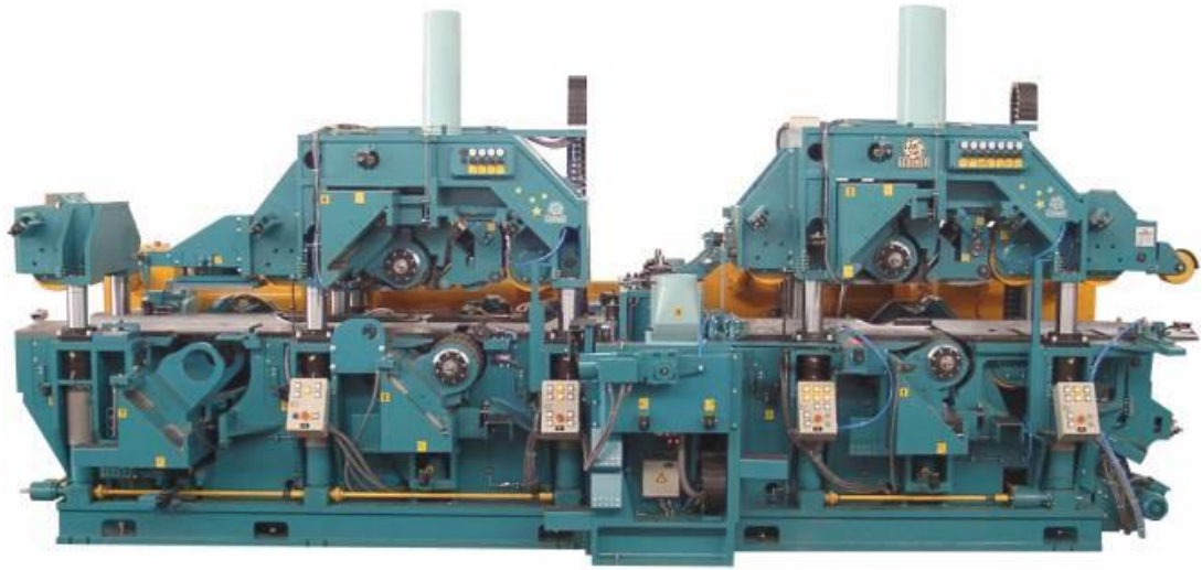
Figuras N° 6.43: Alimentación de cepillado y máquina de cepillado Frema Trade AG de alta capacidad con velocidad de alimentación al cepillado hasta 600m/min.
