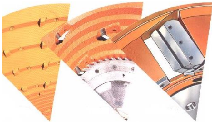
Figura N° 7.27: Herramientas de corte en Chipper Canter. Izquierda es Espiral, el del centro es de Paso y al lado derecho Cuchillos.
