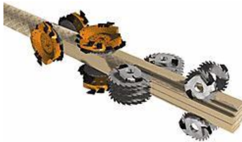
Figura Nº 7.32: Combinación de Sierras Circulares, Cabezales Fresadores Verticales y Horizontales.
