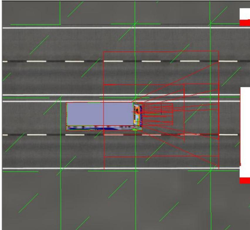
*Figura rango de detención y rango de frenado.*
