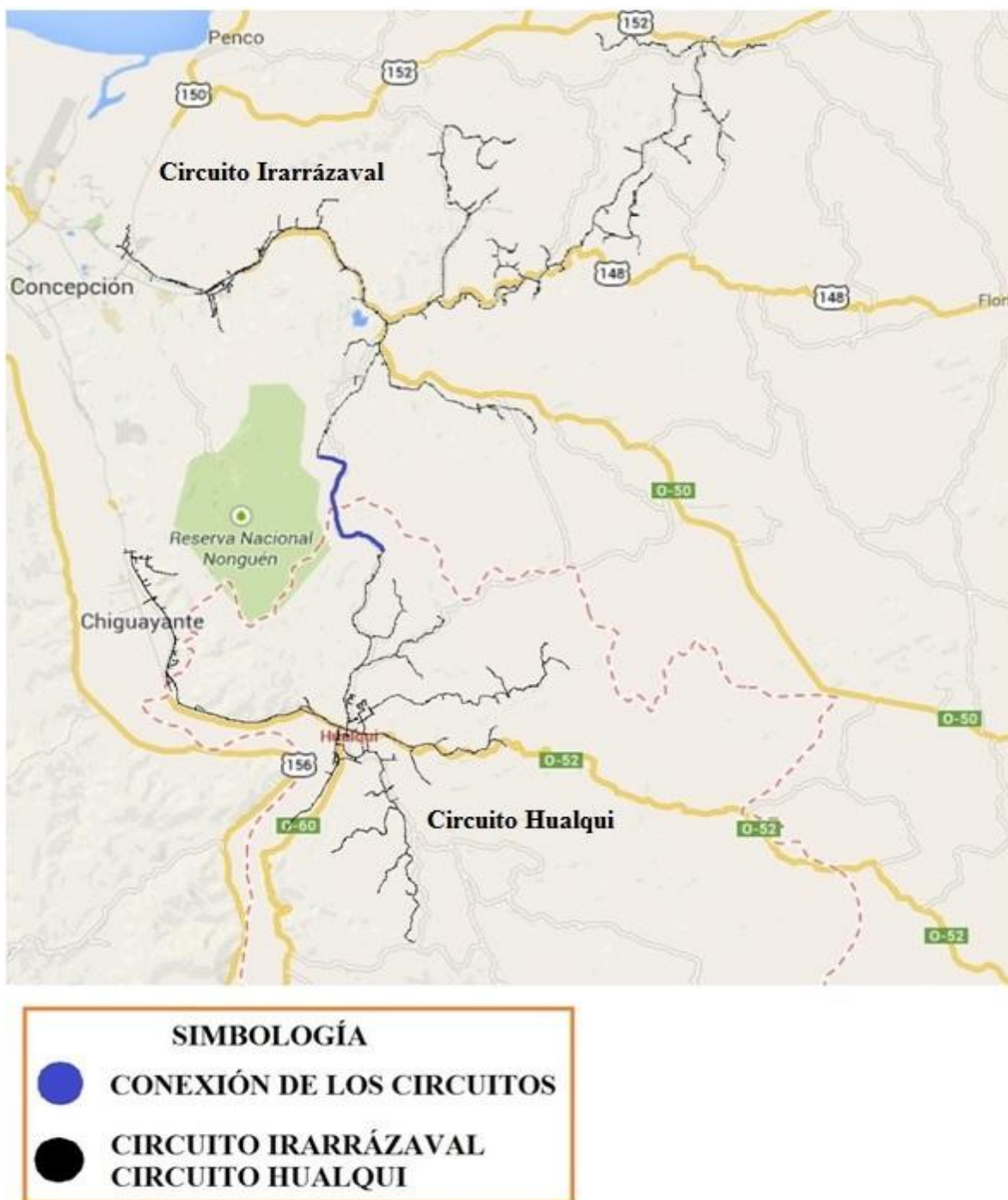
Figura 5.2. Alimentador de 6,2 kilómetros que une el circuito Irrazaval y el circuito Hualqui
