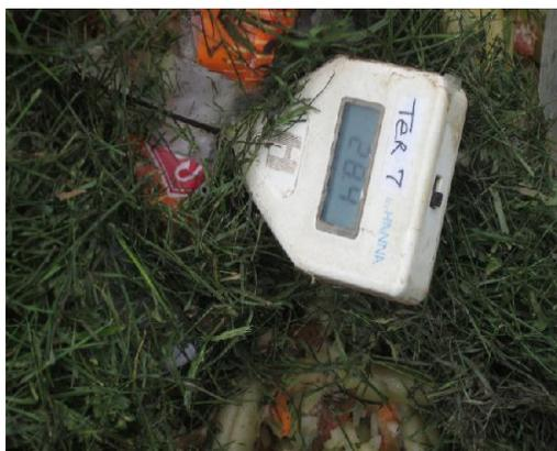
**Figura B.1.2. Uso de termómetro digital con sonda de pincho.**
