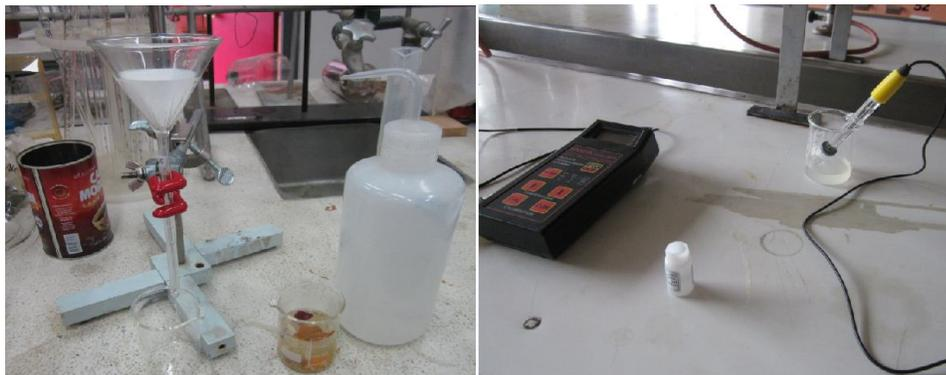
**Figura B.3. Implementos y medición de pH.**
