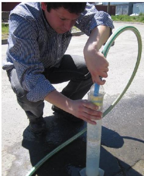
**Figura 1. Estimación tiempo de llenado mediante aforo.**
