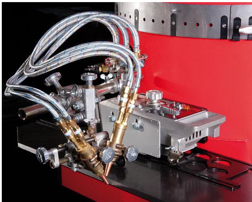
Figura 1.4 Disposición de los Sopletes en ángulo.
