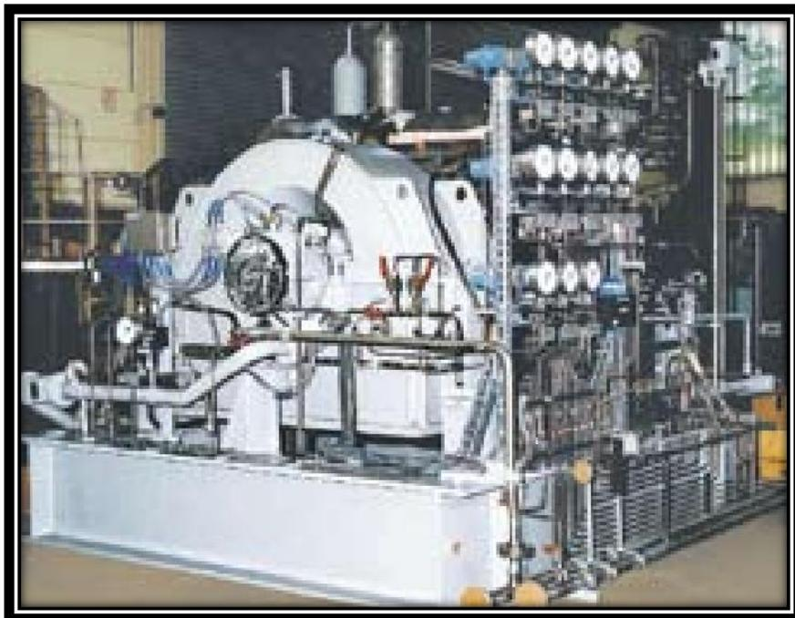
Figura 3.7: Turbina a vapor modelo SST-200 con capacidad de hasta 10 MW
