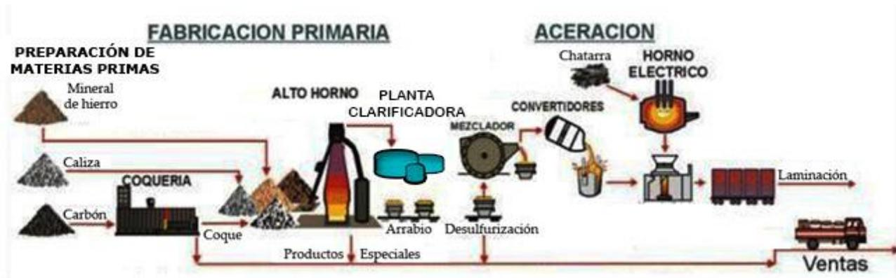
**Figura 1:** Proceso de obtención del acero.
