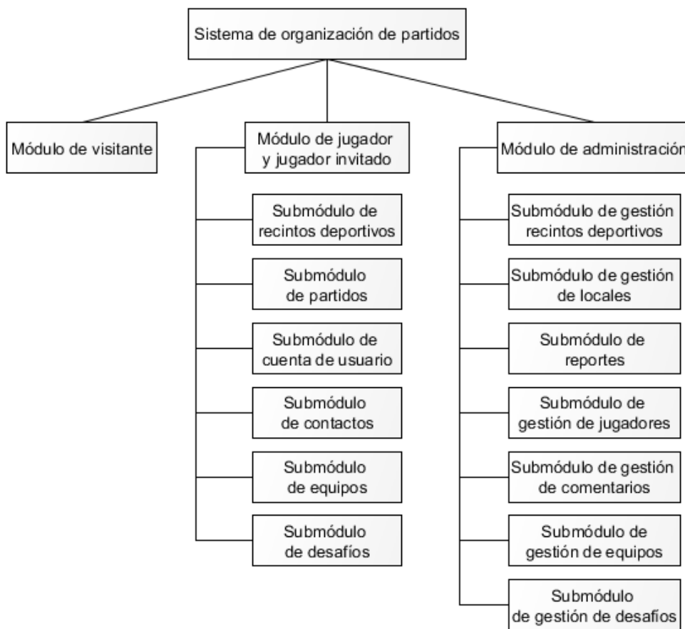
Figura 6.2: Árbol de descomposición funcional del sistema
