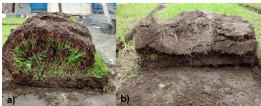
Figura 5: a) Manto enrollado con armadura; b) Manto enrollado sin armadura.
