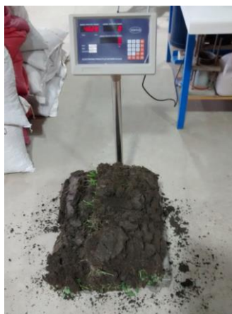
Figura F.2: Determinación del peso de tepe con malla (Fuente: Elaboración propia).
