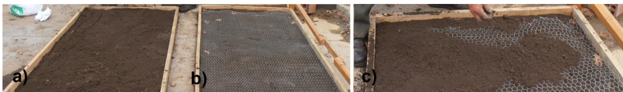
Figura 2. Construcción de mantos. a) Manto de césped natural, b) Manto de césped con incorporación de malla metálica hexagonal, c) Detalle de recubrimiento de malla hexagonal previo al sembrado. (Fuente: elaboración propia).
