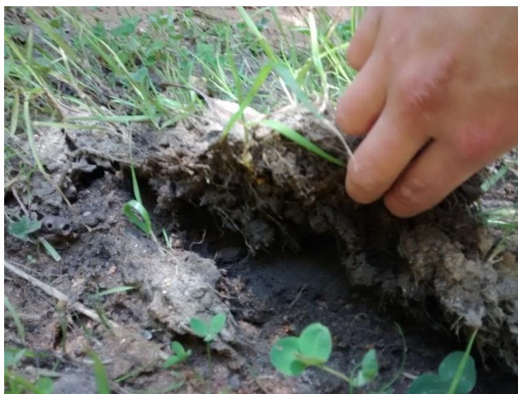
Figura G.8: Enraizado a los 14 días de la instalación del recubrimiento sobre el talud.
