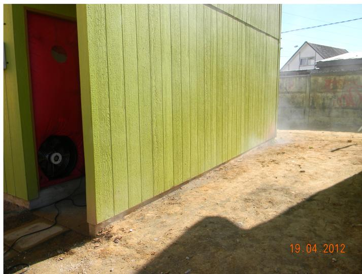
**Figura 9: Técnica de identificación de puntos de fuga con humo. (Fuente: CITEC UBB)**
