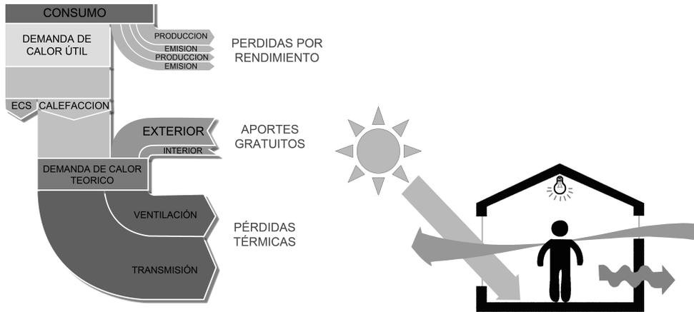
**Figura 2: a) Diagrama Sankey representando el balance energético en régimen de calefacción de una edificación tipo. b) representación esquemática de ganancias y pérdidas a través de la envolvente.** (Fuente: Citec UBB & Decon UC, 2014)
