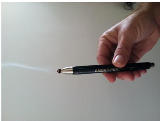
**Figura 7: Lápiz de humo utilizado para encontrar puntos de fuga durante el test de presurización Blower Door (Fuente: <http://www.conservationstrategies.com>)**
