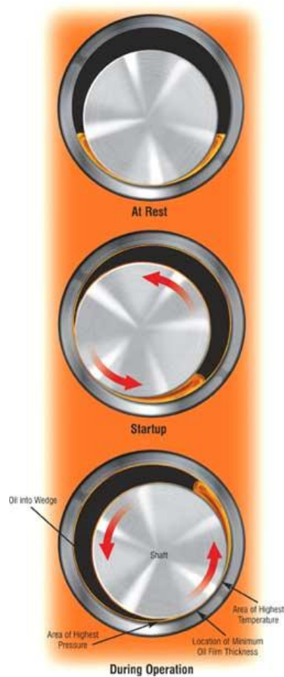
Figura 4-13: Figura superior muestra descanso lubricado cuando el eje no está en movimiento. Figuras inferiores muestran partida y funcionamiento del eje, observándose como el eje va montado sobre la película de aceite.
