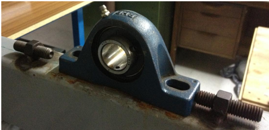
Fotografía 6-3: Descanso de Rodamiento Orientable. Fotografía tomada con el eje desmontado.
