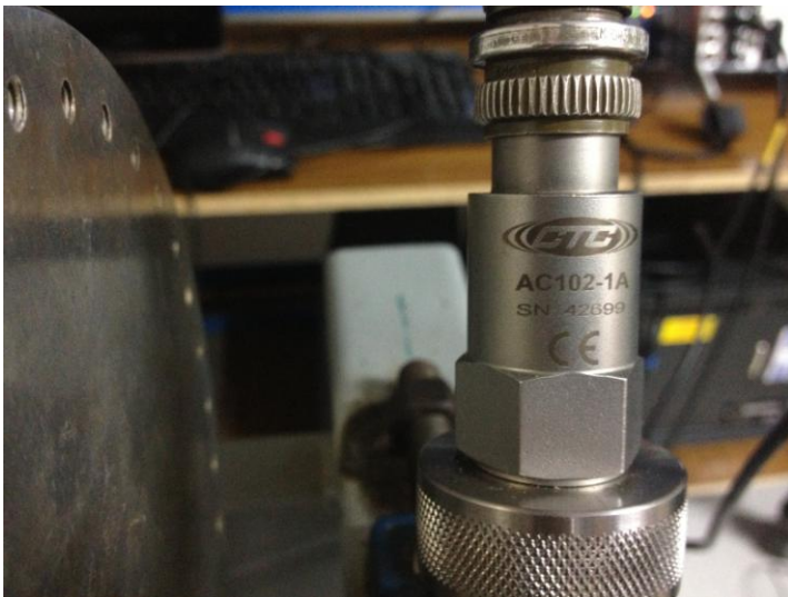
Figura 6-5: Sensor CTC montado en descanso más alejado del motor.
