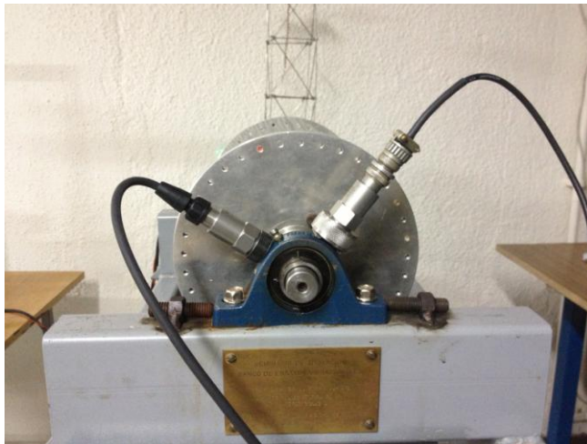
Fotografía 6-8: Sensores instalados para la medición.
