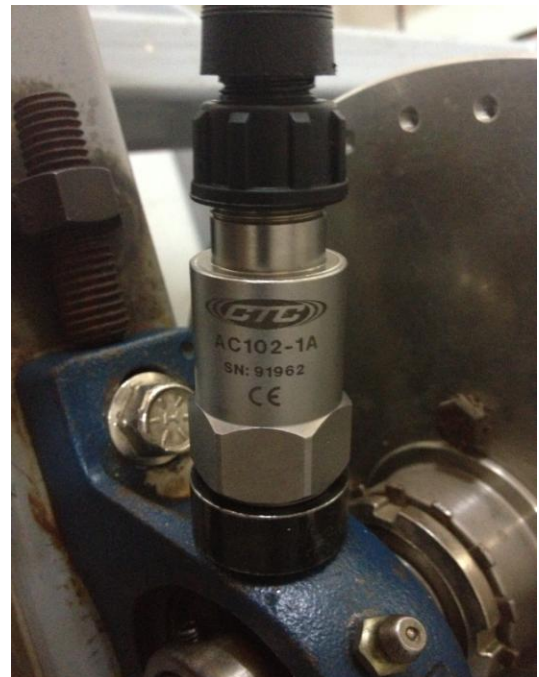
Figura 6-6: Sensor CTC montado descanso en lado motor
