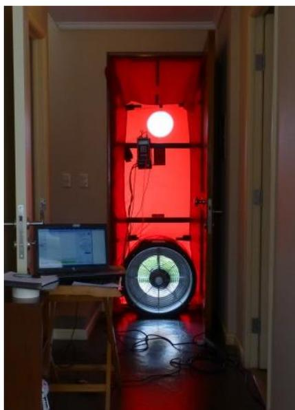
**Figura N°13. Blower door test.**
