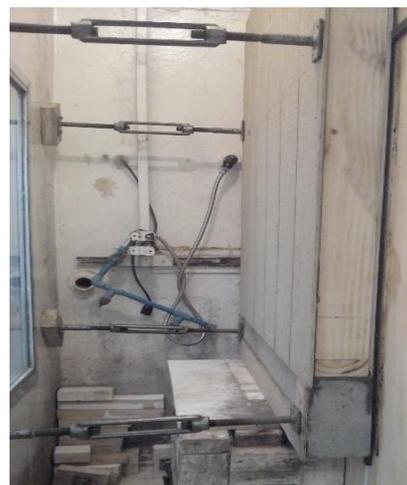
Fotografía N°4 Ensayo encuentro muro de madera-sobrecimiento.
