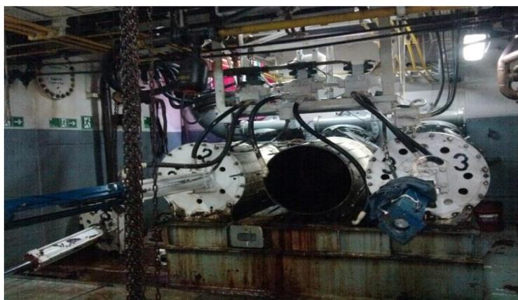
Figura 4.16: Mantenimiento de la bomba Marco de succión de pescado.
