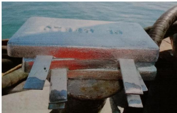
Figura 4.1: Ánodos de zinc listo para instalarse en el pontón Ártica.
