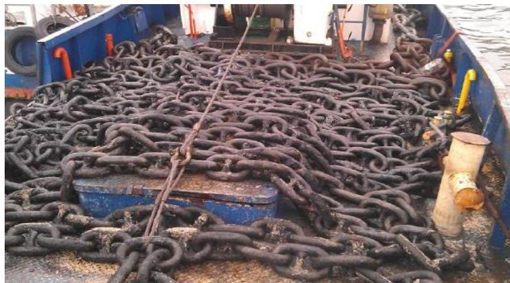
Figura 4.5: Levante de las cadenas de fondeo del pontón Ártica para inspección.
