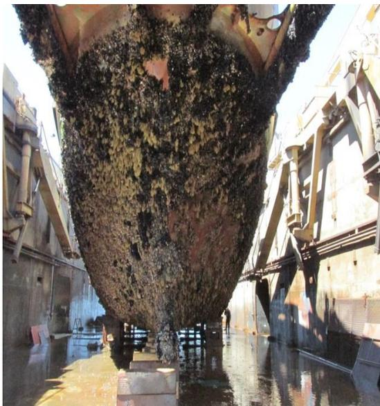
Figura 4.9: Obra viva del pontón Ártica para ser carenada en dique.
