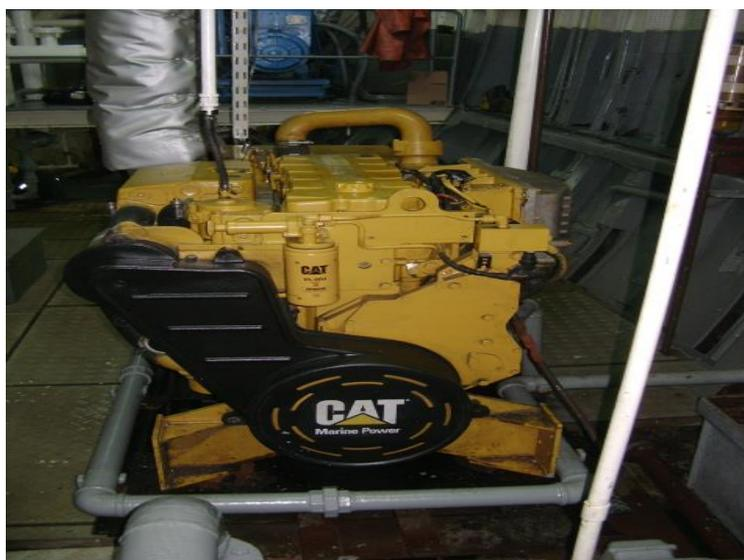
Figura 4.17: Motor generador Caterpillar C9 del pontón Ártica.
