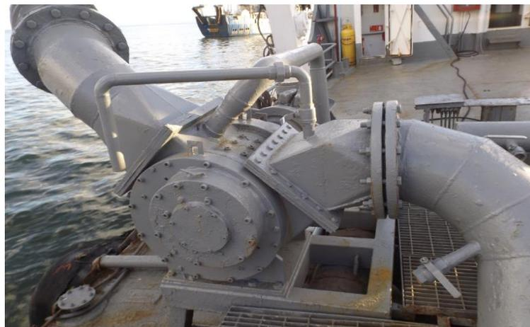
Figura 4.19: Bomba Lamella del pontón Ártica.
