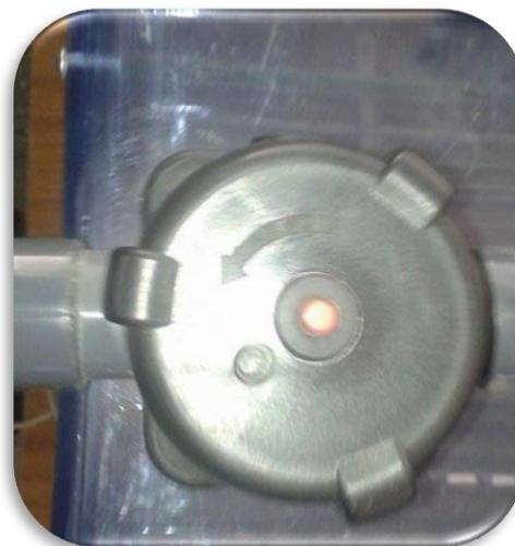
Para realizar el ensayo con variación de RPM se debe de tener abiertas las válvulas de globo sin variar, incrementar en forma gradual las rpm tomando mediciones desde el mínimo de rpm permitido, 1500 rpm, hasta el máximo, en este caso 3000 rpm.
