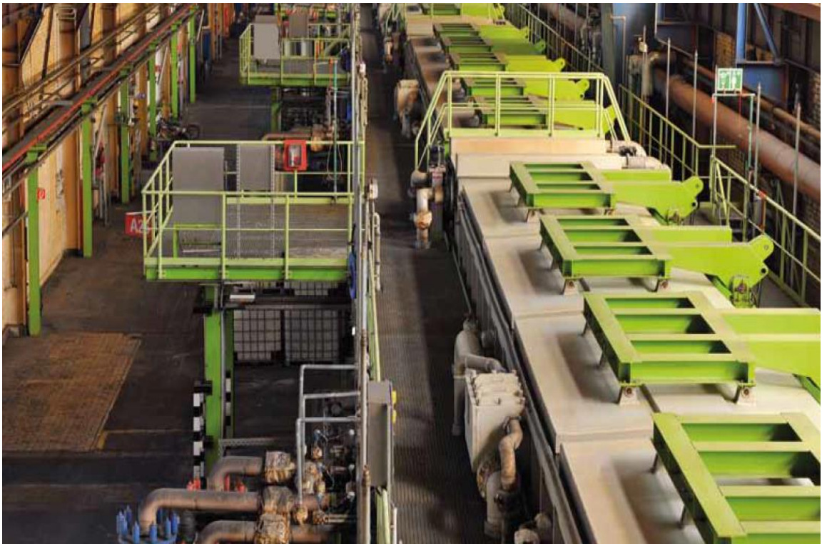
Figura N° 3.3.3.2, Línea de decapado.
