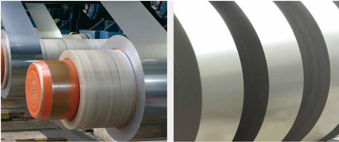
Figura N°3.3.3.11c, Corte de chapa en fleje.
