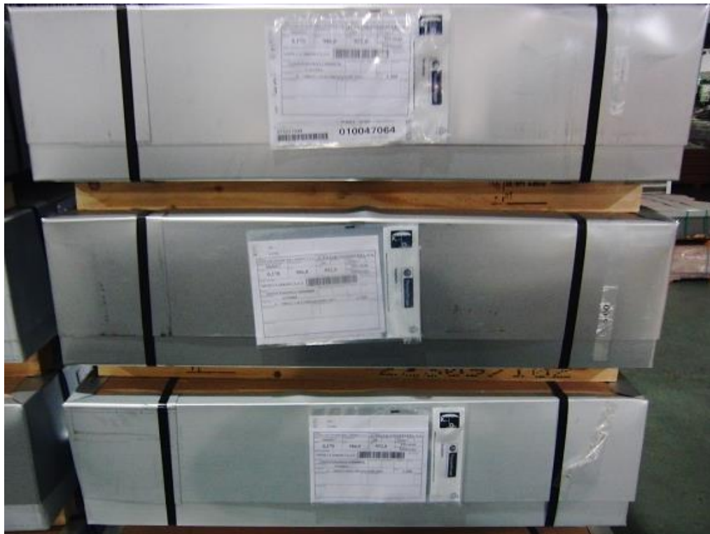
Figura N°3.3.3.13b, Embalaje en bulto cerrado para transporte marítimo.
