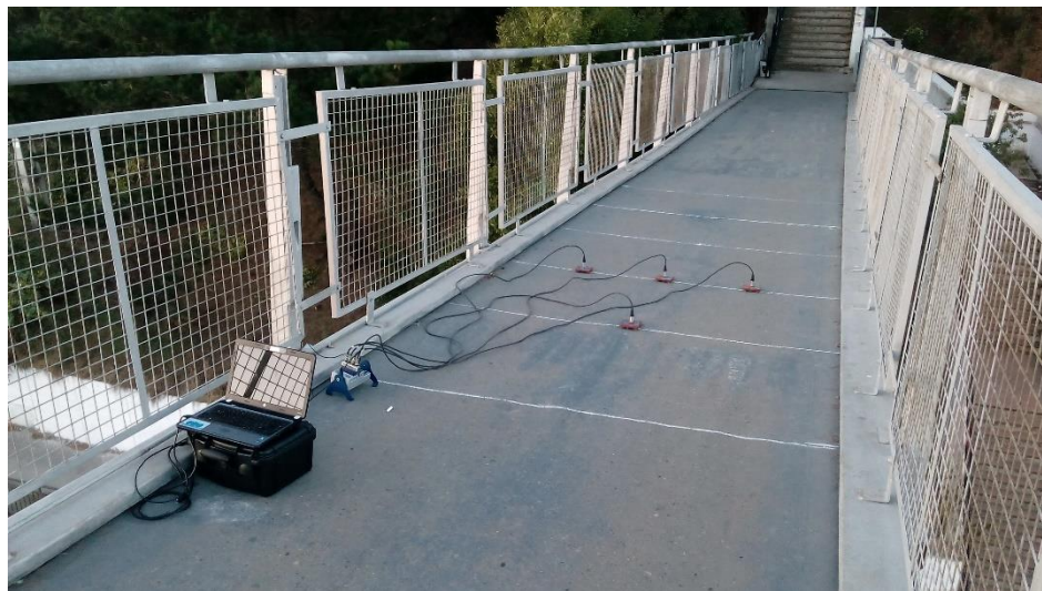
Figura 7. (a) Disposición del equipo para mediciones heel drop
