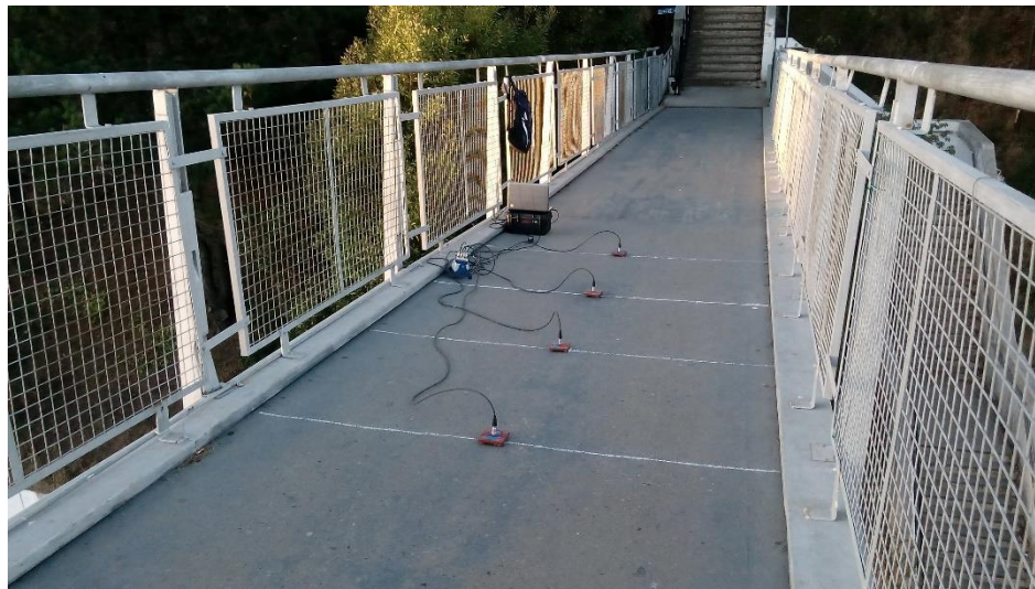
Figura 8. (b) Disposición de los acelerómetros para mediciones de caminatas sincronizadas
