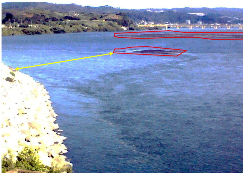
Figura 29. Dunas de arena emergiendo entre Puente Ferroviario y puente Juan Pablo II. Distancia entre Duna de arena y orilla del cauce: 15 metros aproximadamente.
