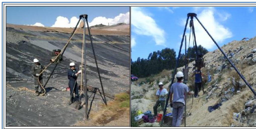
Figura F4. Ensayo de penetración dinámica CPT din
