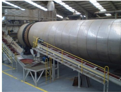
Fig.2.12. Cuerpo de secador.
