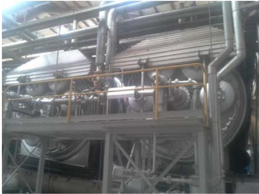
Fig.2.11. Secadores rotatorios.
