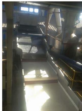
Fig.2.2. Desaguador estático.
