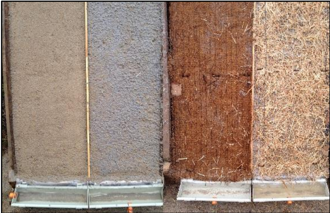
Figura C.8.1. Material decantado en canaletas de pvc.
