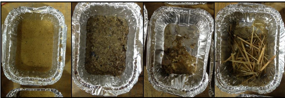
Figura C.8.4. Pailas con material decantado en las canaletas, luego de un evento lluvioso (Talud Solo, Hidrosiembra, B. fibra de coco y B. paja de trigo respectivamente)
