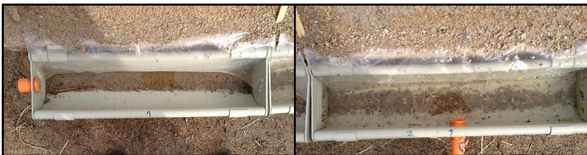
Figura C.8.2. Material arrastrado en un talud descubierto y un talud con hidrosiembra (1ra Semana)
