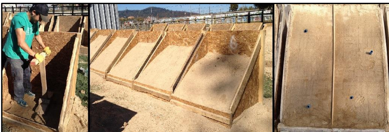
Figura 6. Compactación y toma de densidades (Fuente: Elaboración propia)
