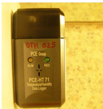
Figura 4.1: Data Logger: Modelo PCE-HT71 de PCE Group
