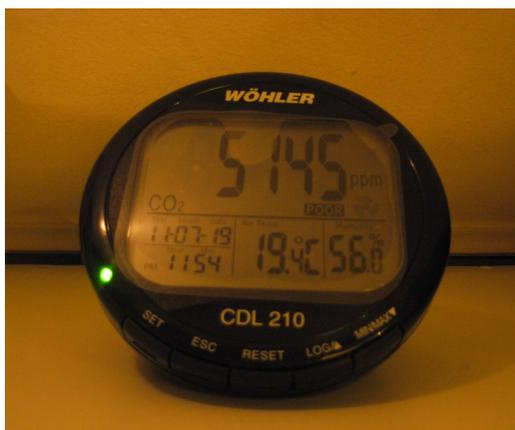
Figura 4.9: Sensor de CO<sub>2</sub>: Modelo CDL 210 de Wöhler.
