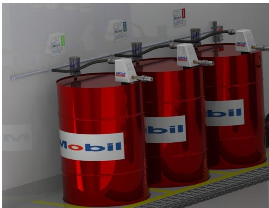
**Figura 4.5 Tambor equipado para evitar contaminación**
