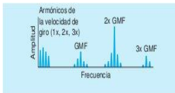
Figura N°6.8: Espectro característico de engranajes desalineados.
