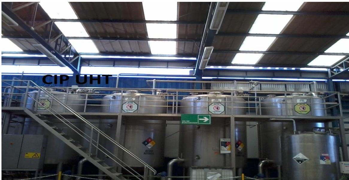
Figura 2.6, CIP automático UHT
