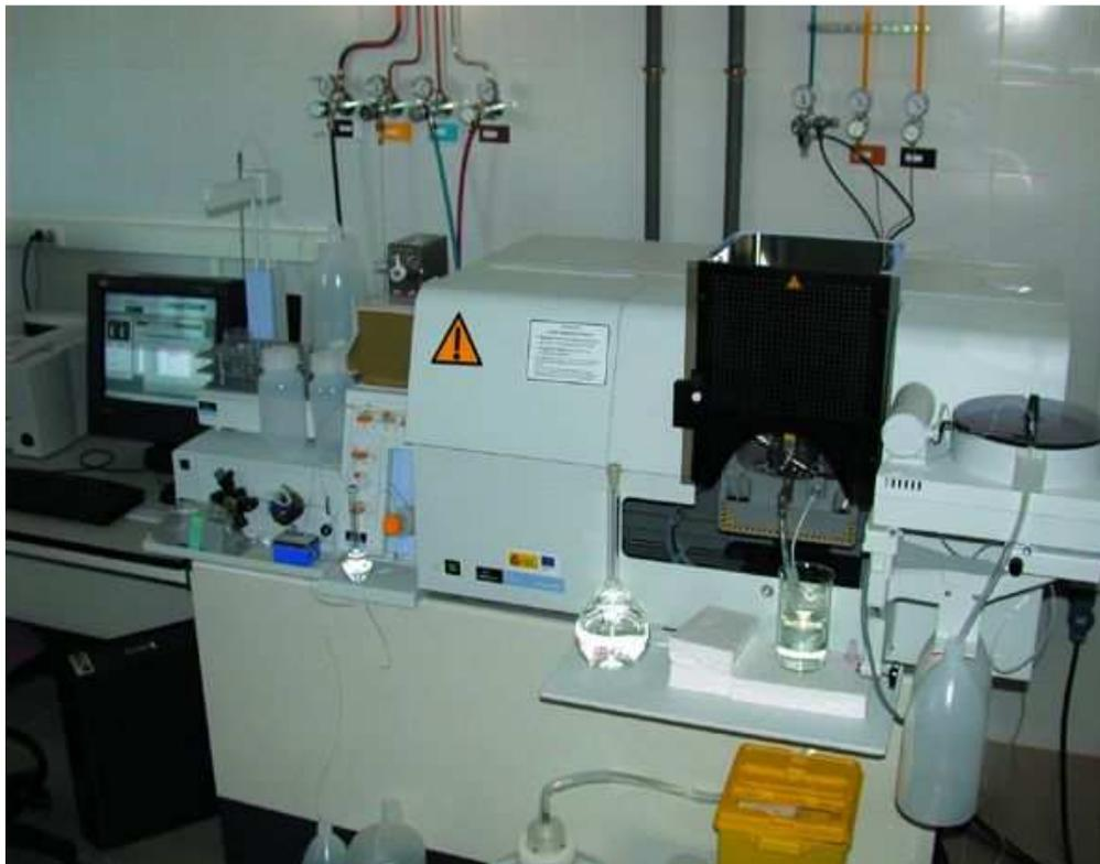
**Figura C.3. Espectrofotómetro de absorción atómica.**
