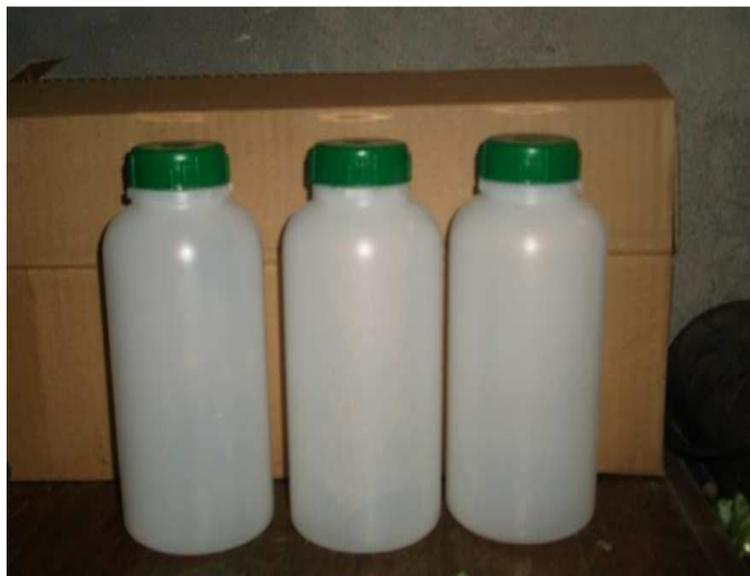
**Figura C.2. Envases de polietileno de alta densidad para la toma de muestras.**
