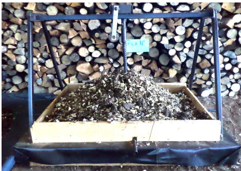
Figura 5: Pila de aireación pasiva con mezclador mecánico
