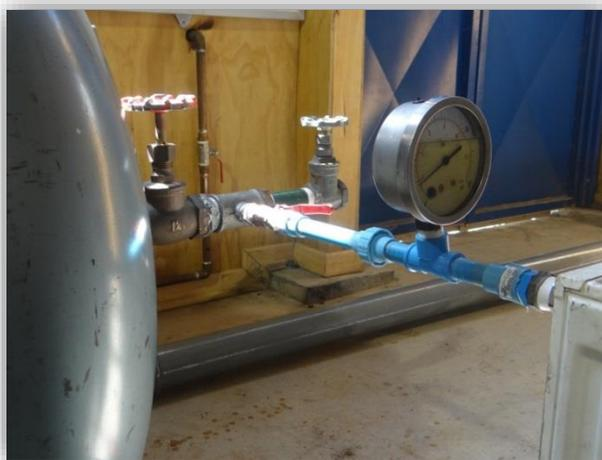
Figura 5.15 Manómetro y llave de paso que aíslan el circuito para la prueba neumática.
