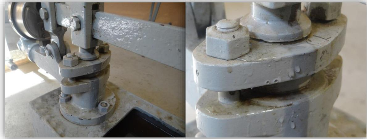
Figura 5.20 Fuga del fluido de prueba a través de la bomba manual.
