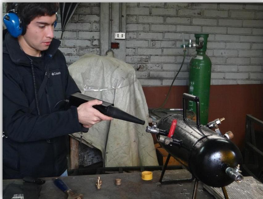
Figura 5.6 Inspección mediante el Ultraprobe 2000.
