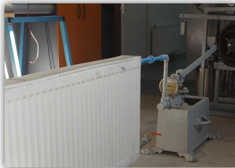
Figura 5.18 Montaje prueba hidrostática.
