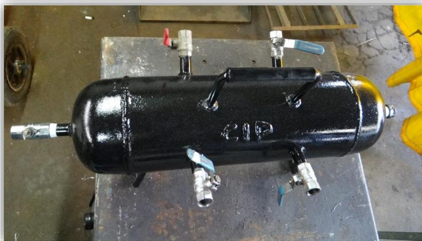
Figura 5.3 Manifold a ensayar.
