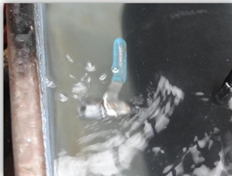
Figura 5.5 Manifold sumergido en agua.
