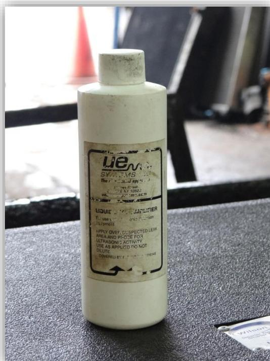
Figura 5.7 Líquido amplificador de fugas.
