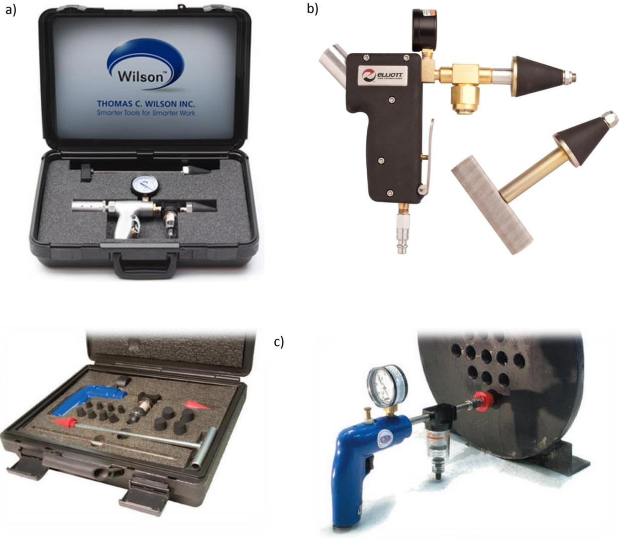
Figura 4.3 Equipos VLD. a) Kit VLD Wilson. b) VLD Elliot. c) Kit VLD de USA INDUSTRIES, Inc.
