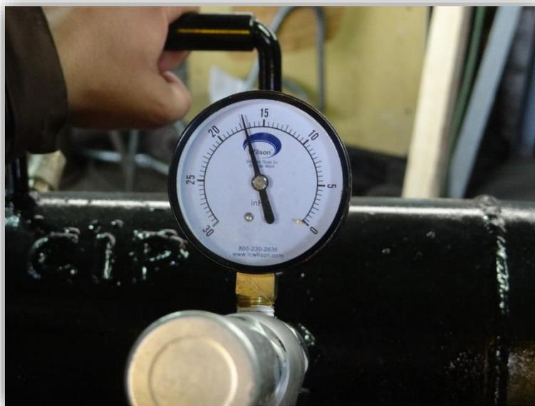
Figura 5.9 Vacuómetro VLD.
