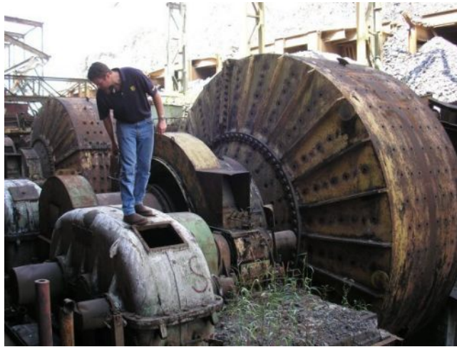
Figura 1.7: Tambores de molienda para el cobre. En el interior se mezcla material de cobre —tal como viene extraído de la mina— con bolas de acero y se somete éste a movimientos de rotación del tambor, como resultado del proceso se produce una granulado más fino del material que contiene el cobre y que es sometido posteriormente a otros procesos.
