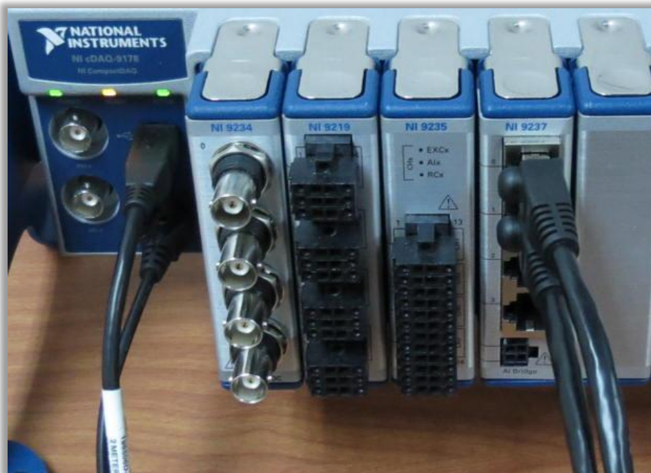
Figura 4.24: Conexión de la Tarjeta NI 9237.
