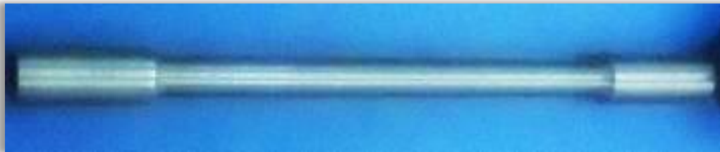
Figura 6.1: Probeta acero inoxidable AISI 316 (Diámetro mayor 14 mm, diámetro menor 10 mm. largo total 180 mm).
