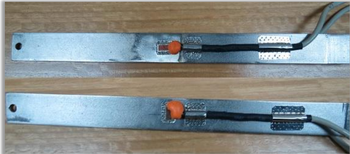
Figura 4.17: Strain Gage instalados en viga de acero inoxidable.
