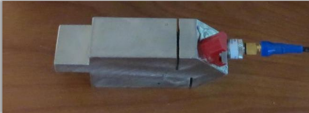
Figura 5.3: Medición Velocidad transversal con Palpador recto y zapata de 45°.
