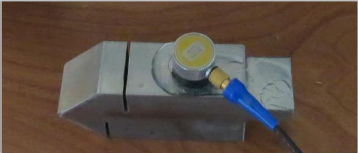
Figura 5.2: Medición Velocidad Longitudinal con Palpador recto, probeta acero inoxidable la cual consta de dos secciones de 10 y 40 mm. Necesarios para la medida de velocidad longitudinal y dos secciones en ángulos de 45° de 5 y 15 mm (al lado izquierdo de la imagen) necesarios para medir velocidad transversal.
