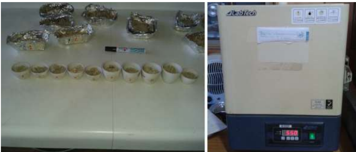
Figura D13:muestra en crisoles y mufla. (Fuente: Elaboración propia)
