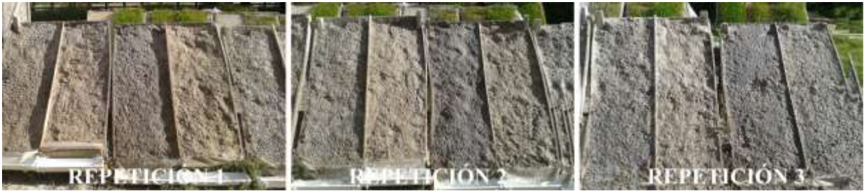
Figura D9: Hidrosiembra aplicada (Fuente: Elaboración propia)
