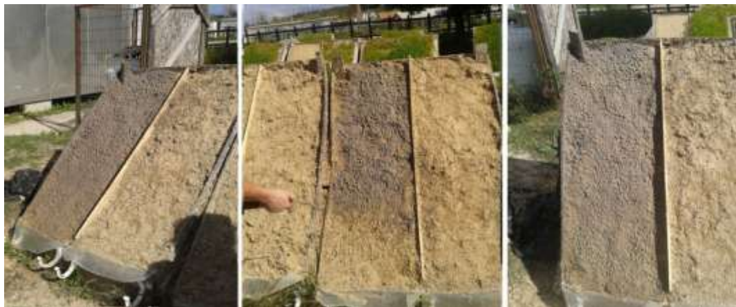
Figura D8: Aplicación de la hidrosiembra en los lisímetros. (Fuente: Elaboración propia)
