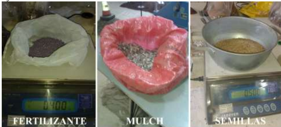
Figura D3: Dosificación elementos de la hidrosiembra tradicional. (Fuente: Elaboración propia)
