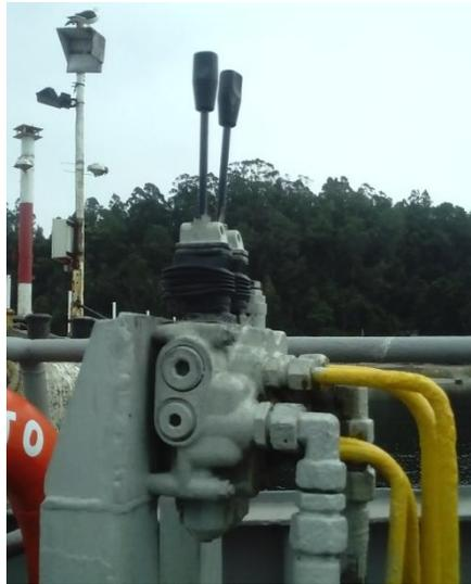
Figura 2.5.- Válvula direccional winche rampa y maniobra de fondeo.
