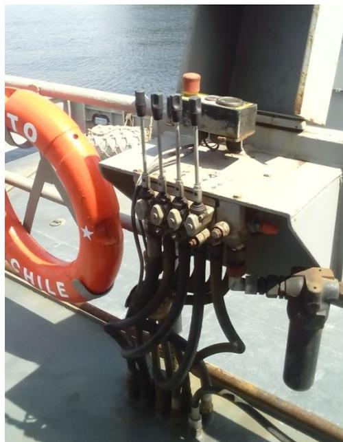
Figura 2.10.- Válvula direccional grúa hidráulica.
