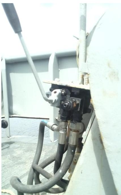
Figura 2.8.- Válvula direccional maniobra de codera.
