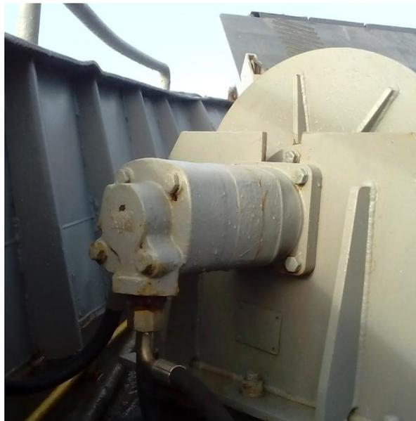
Figura 2.6.- Motor hidráulico maniobra de fondeo.
