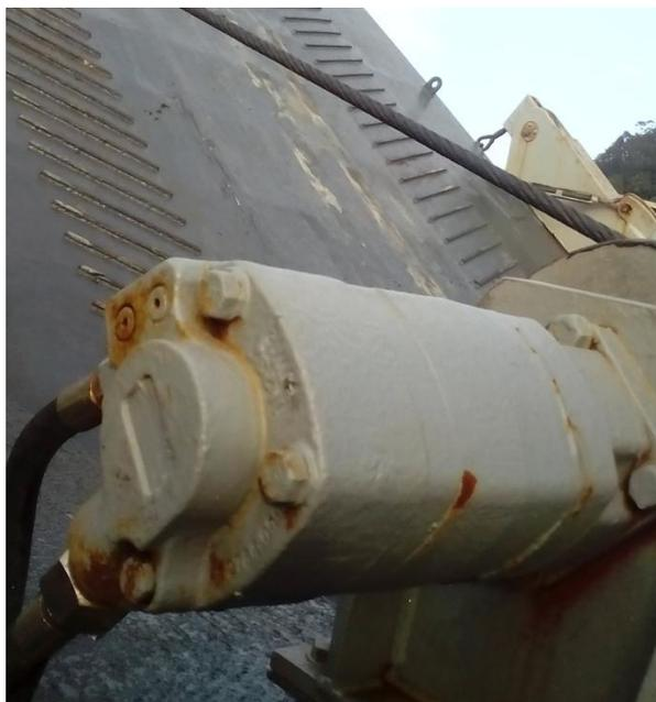
Figura 2.4.- Motor hidráulico rampa.
