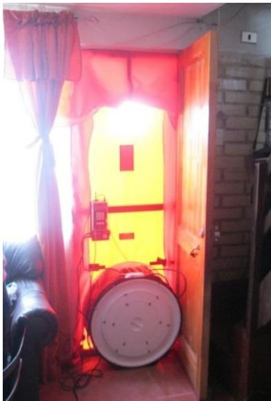
**Figura 5.6: Inicio del Blower Door Test.**
