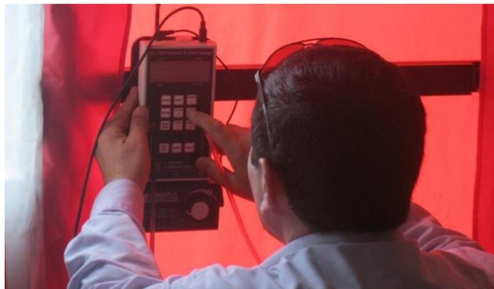
**Figura 5.4:** Dispositivo donde se ingresan los datos fijos de la vivienda (Temperatura, volumen de la vivienda, área del piso y de la envolvente).
