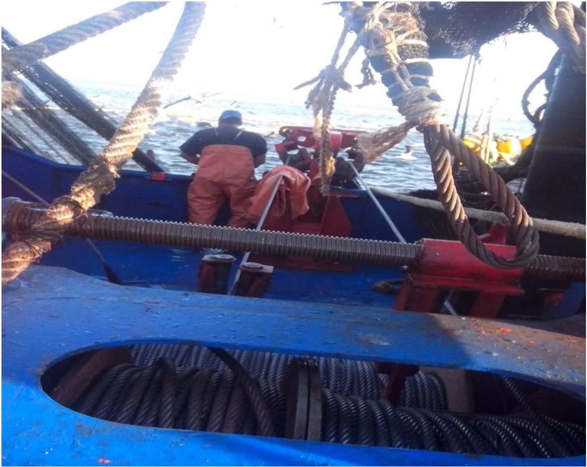
Imagen 1.5 Winche cascada en operación.
