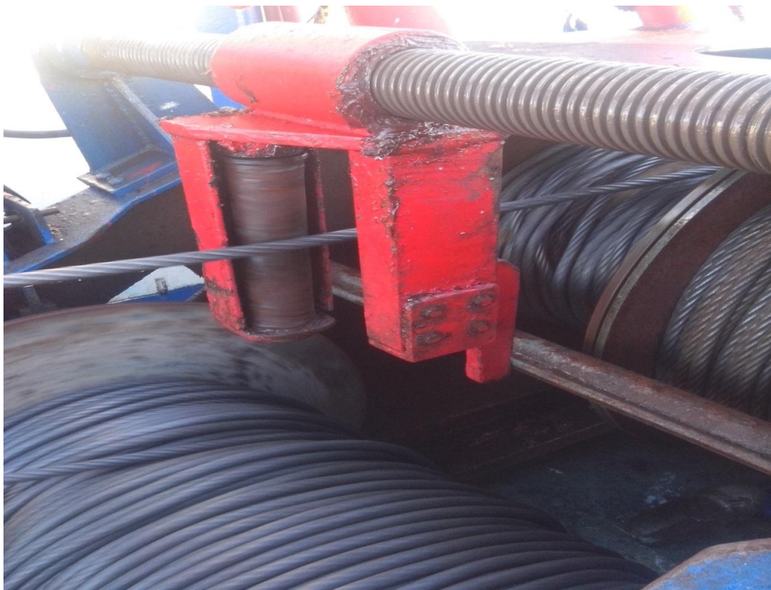
Imagen 3.2 Detalle operativo del tambor del puntero.
