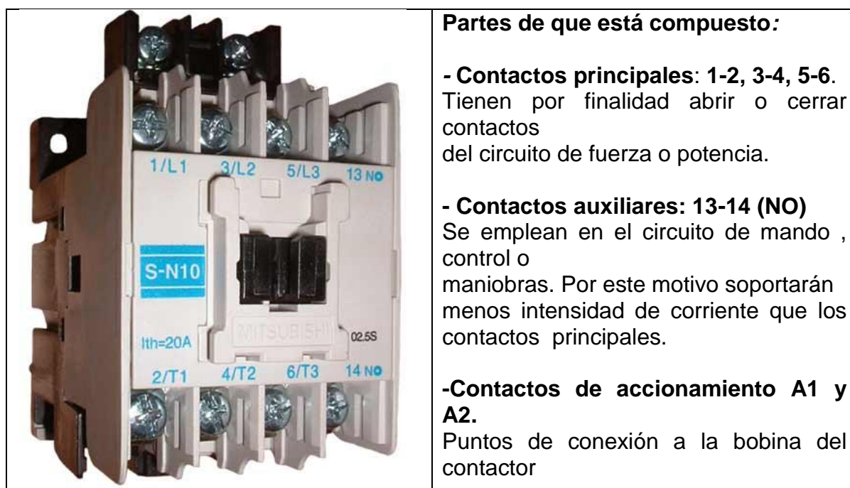
Figura N° 6.2 Aspecto físico de un contactor.
