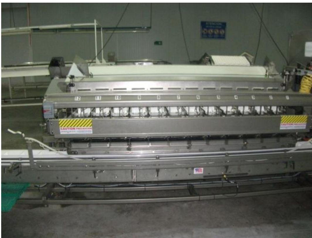
Figura N° 3.2 Antigua máquina usada para llenar potes pequeños
