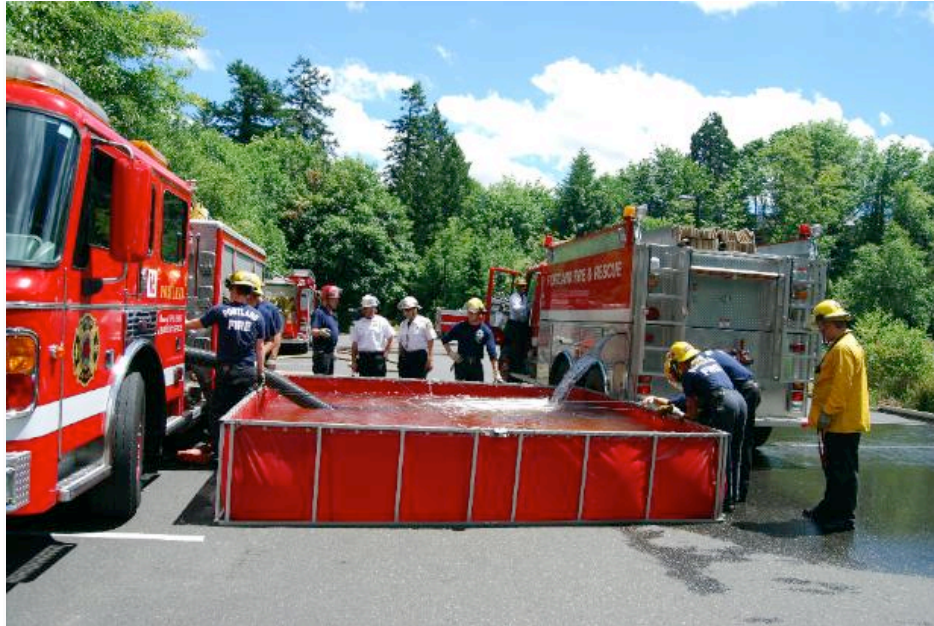
Fig. 3.5 Foto que ejemplifica el trabajo con piscina, al centro, camión cisterna descargando su contenido en estanque auto soportable, a la izquierda, en primer plano, carro aspirando y bombeando hacia la armada de ataque.
