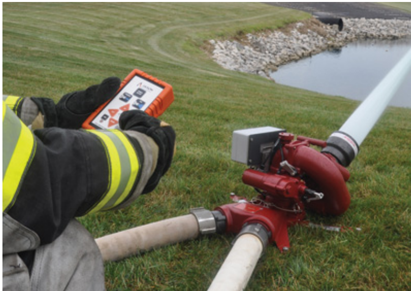
Fig. 1.12 Pitón Monitor de piso 1900-3800 LPM
