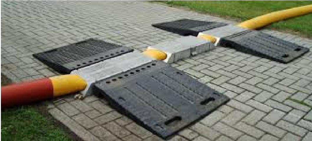
Fig. 3.10 Elemento que permite la circulación de vehículos sobre las mangueras sin provocar daño y sin obstaculizar el tránsito en las calles
