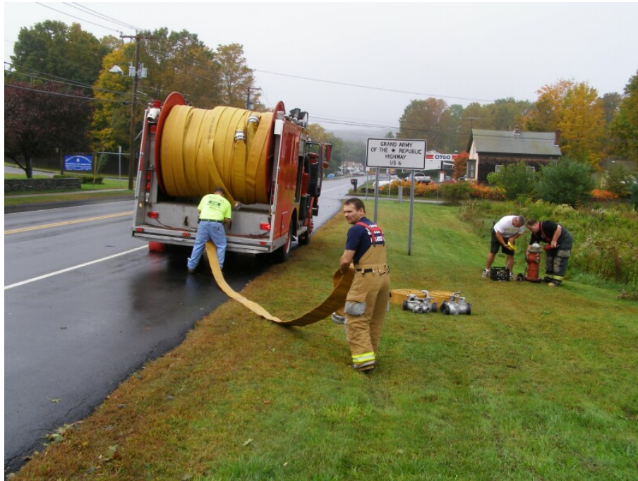
Figura N°1, Camión de Bomberos con 6000 pie (1828 m) de manguera de 5 pulgadas (125 mm)
