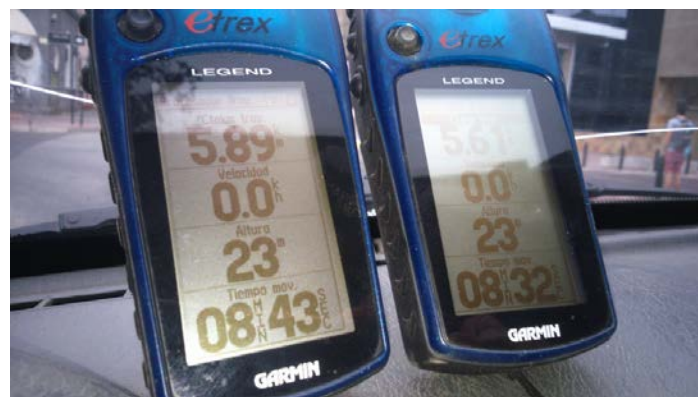
Fig. 3.7 Medición de cota en centro comercial 23 m.s.n.m.
