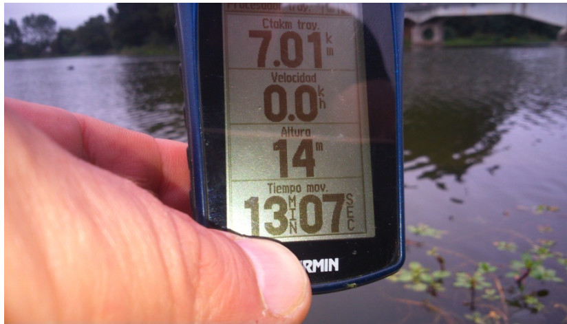
Fig. 3.8 Medición de cota en fuente de agua 14 m.s.n.m.
