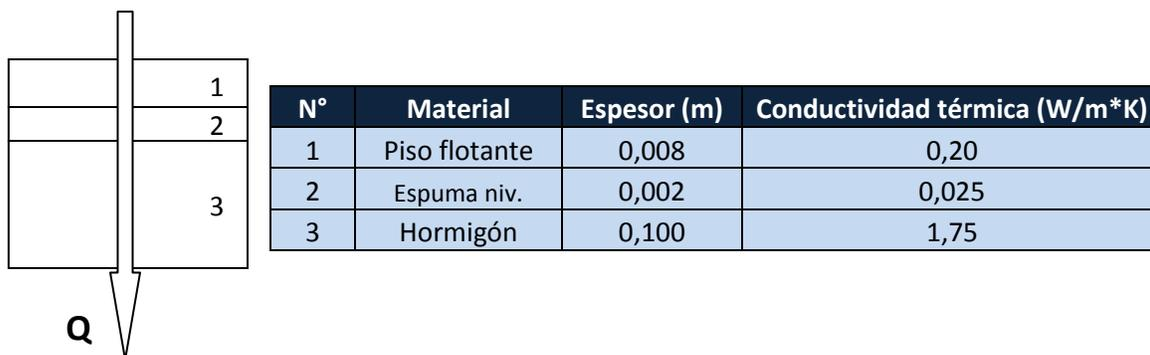
Para la cocina y los baños el piso está compuesto de 10 cm de hormigón y sobre éste hay piso cerámico.
