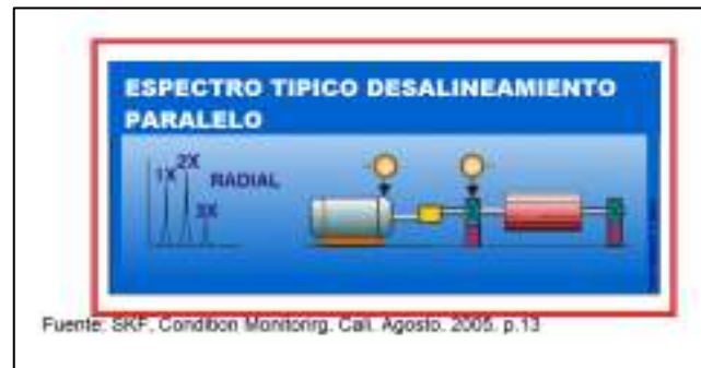
Figura 5.5: Espectro característico de un desalineamiento paralelo
