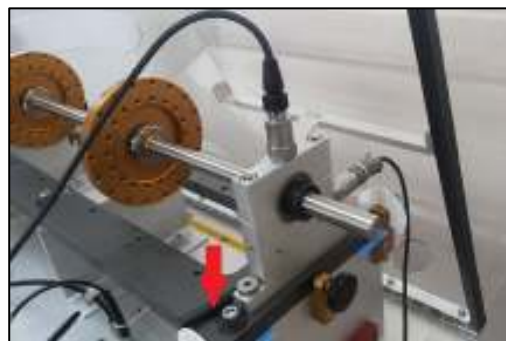
Figura 6.2: Posición de trabas indicando que el banco de ensayo se encuentra alineado
