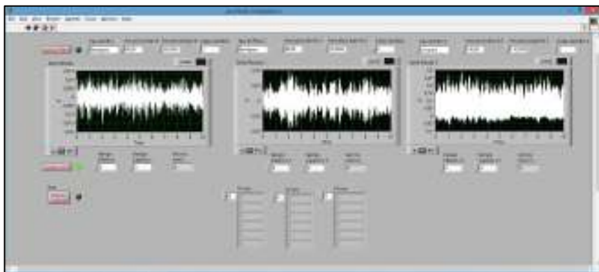
Figura 8.3: Panel frontal del programa generado para medir valores RMS por componentes usando traslapado y filtro de señales
