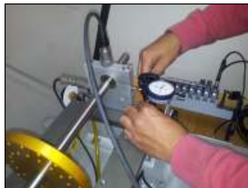
Figura 6.1: Posición del reloj comparador en el punto de medición 4
